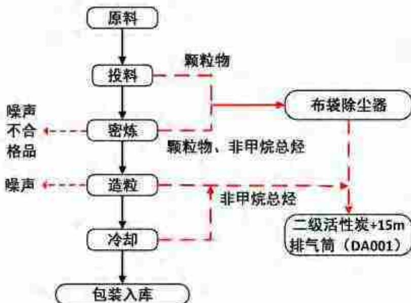
图 2-1 TPR 颗粒生产工艺流程及产污环节图
