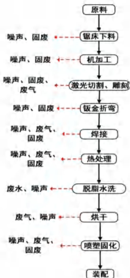
图 2-4 生产工艺流程及产污环节图
