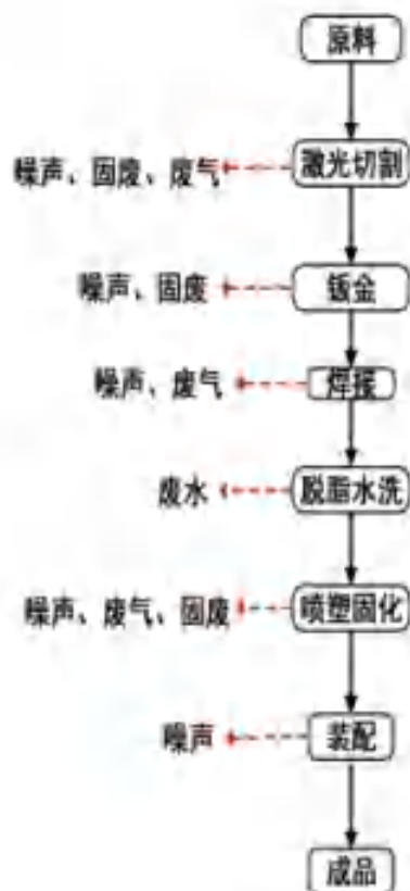
图 2-5 现有生产工艺流程及产污环节图
